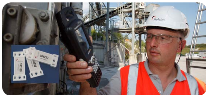
Durch eine RFID-gestützte Lösung beim Baustoffproduzenten Holcim kann der Lkw-Fahrer über ein Mobilterminal für den Beladevorgang die korrekte Anfahrstelle identifizieren. Bildquelle: © Holcim (Schweiz) AG
