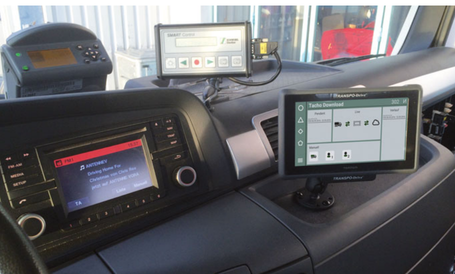
Hier rechts im Cockpit ist das «Transpo-Drive 2015» im Einsatz, auf dieser Lkw-Navigation laufen auch die Logistikkdaten-Erfassung sowie Apps für die Steuerung von Arbeitsabläufen.
