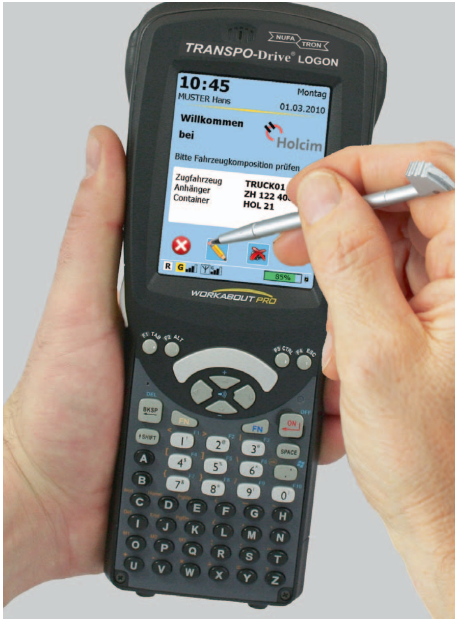
Das robusten Handheld Terminal «Workabout Pro» von Psion Teklogix (Schutzklasse IP65). (Bilder: Psion Teklogix)
