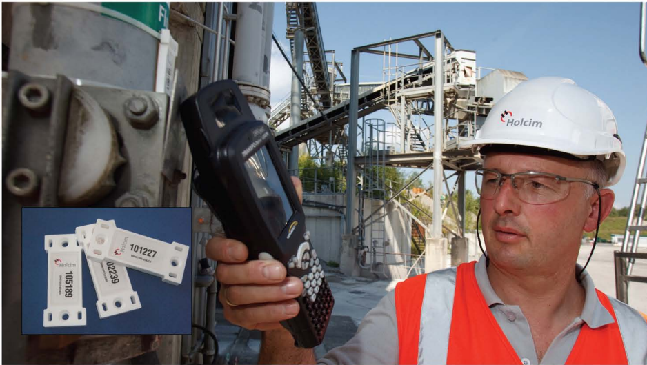
Ein Mitarbeiter scannt einen RFID-Transponder. Bild im Bild: kundenspezifische RFID-Transponder.
