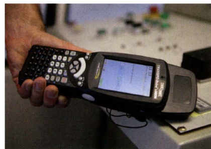
Die eingesetzten Handhelds bei Holcim sind die Hardwarebasis für das mobile Telematiksystem Transpo-Drive Logon.
