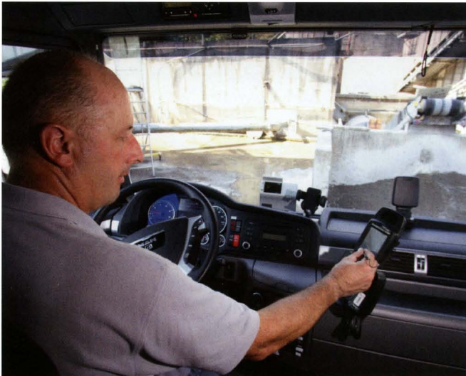
Der Fahrer scannt mit seinem Handheld das jeweilige Silo, um Fehlbefüllungen zu vermeiden.
